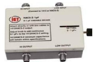
HACS-Z 可変ディケード: 1 pF+, メインユニットにプラグイン, 連続下0-1pFの並列キャパシタンス を付加
